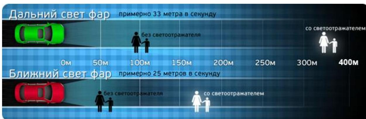
Как наглядно видно из рисунка, передвигаясь в темное время суток с ближним светом фар, водитель видит пешехода только на расстоянии не более 50 метров (около 30 м. в реалии), а пешехода со светоотражателем – почти на 150 – 200 м.
