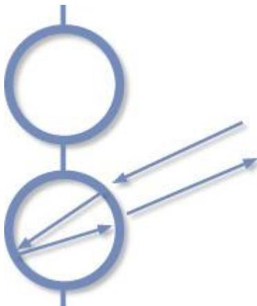
При обратном отражении луч света, падающий на отражающую поверхность, отражается обратно по направлению к источнику света.
