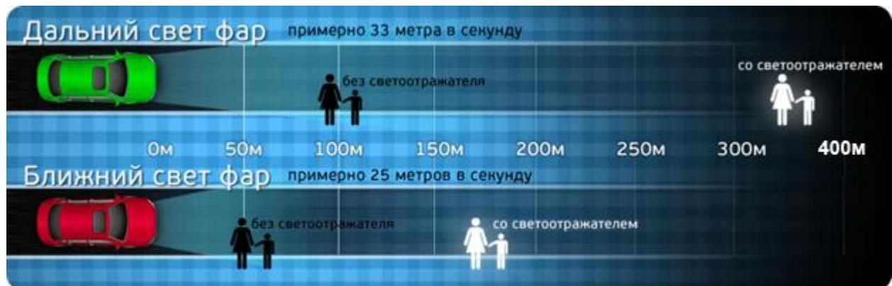
Как наглядно видно из рисунка, передвигаясь в темное время суток с ближним светом фар, водитель видит пешехода только на расстоянии не более 50 метров (около 30 м. в реалии), а пешехода со светоотражателем – почти на 150 – 200 м.
