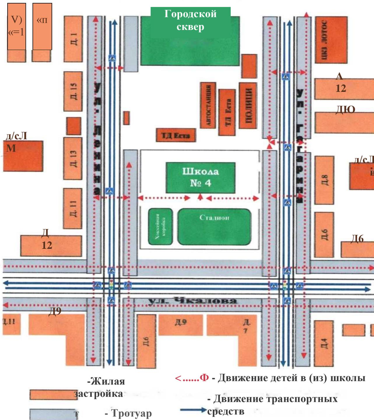
Рисунок 1 Схема организации дорожного движения в непосредственной близости от образовательной организации с размещением соответствующих технических средств организации дорожного движения, маршрутов движения детей и расположения парковочных мест
